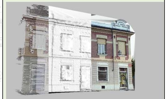
Attraverso la combinazione delle tecnologie di rilevamento e di restituzione si possono infine produrre modelli texturizzati degli oggetti all'interno dei quali "navigare"
